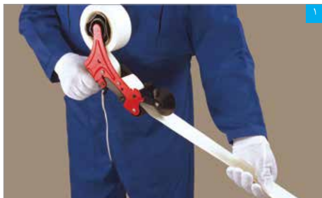
خم کردن نوار درزگیر با دستگاه تازن
