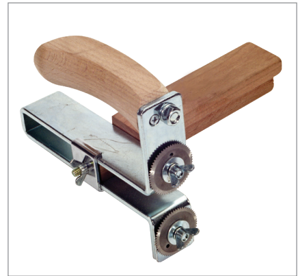
دستگاه برش قرقه‌ای: جهت برش پنل به صورت نوازی و سری‌کاری با سرعت اجرای بالا
