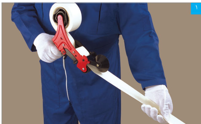
خم کردن نوار درزگیر با دستگاه تازن
