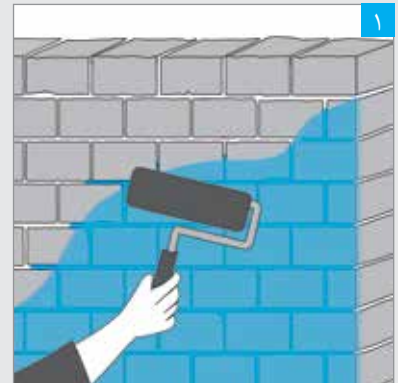
اجرای لایه پرایمر
