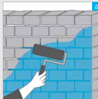
اجرای لایه پرایمر بر روی سطح زیر کار
