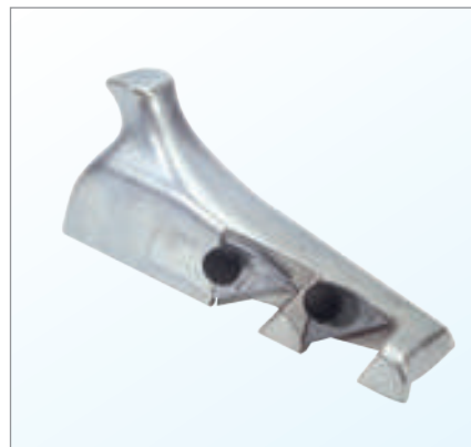
پخ زن: جهت اجرای پخ ۲۲/۵° و ۴۵° در لبه‌های برش خورده پنل برای بتونه کاری صحیح
