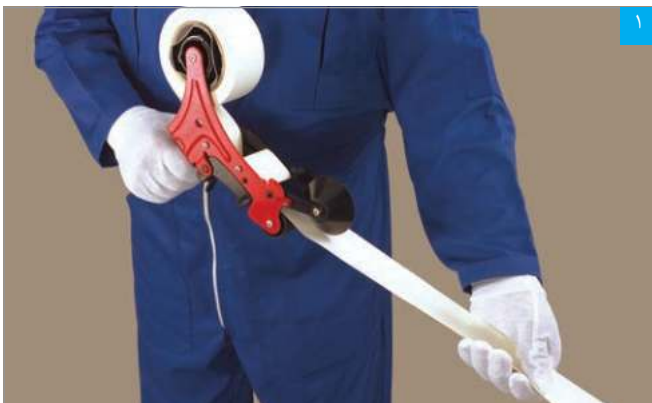
خم کردن نوار درزگیر با دستگاه تازن
